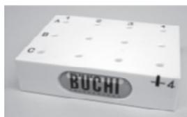
Le support d'échantillons est marqué d'un repère de remplissage à 4 mm.
